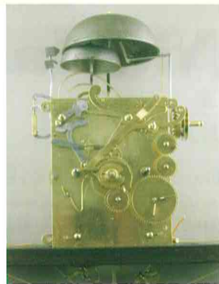
5. Voorzijde, de bellen zijn op halfrond gebogen steunen geplaatst
