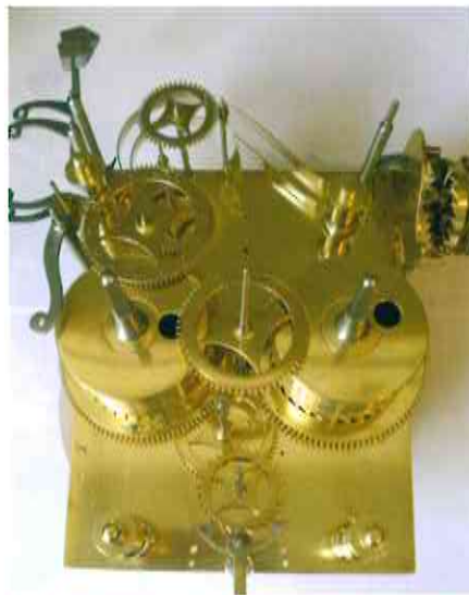
4. Binnenzijde van het uurwerk met de onderin geplaatste ankerang
