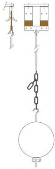
Afbeelding 13 – Ketting en veer; tekening vervaardigd door Fred Kats ©
